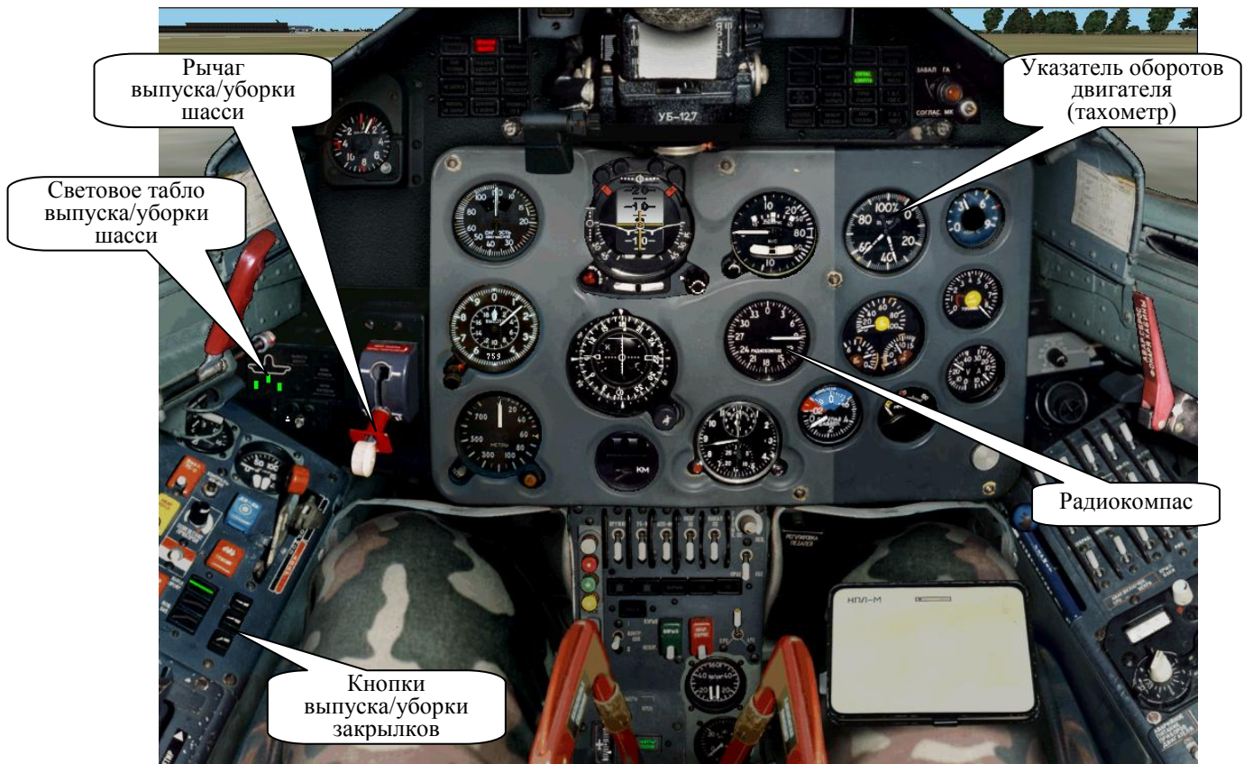
Центральная приборная панель передней кабины самолета Л–39
