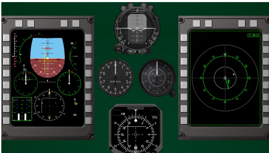
Вариант имитации приборной индикации пилотажного стенда с широкоугольной цифровой системой визуализации
