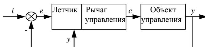
Рис.1. Замкнутая система «самолёт-лётчик» применительно к задаче компенсаторного слежения. Здесь  $i(t)$  – входной сигнал,  $y(t)$  – выходной сигнал,  $c(t)$  – управляющий сигнал,  $e(t)$  – сигнал ошибки (рассогласования)
